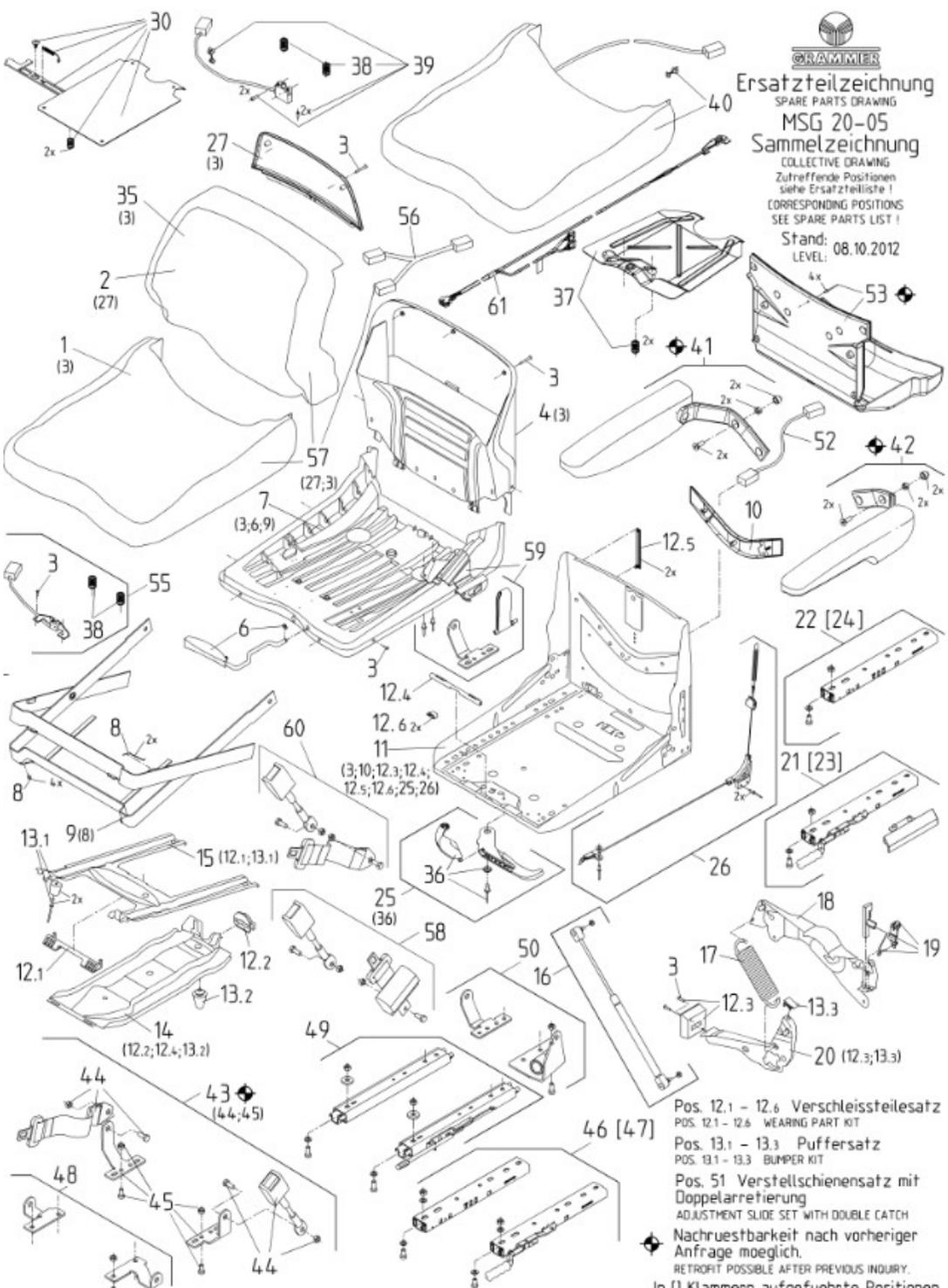
Pos. 12.1 - 12.6 Verschleisssteilesatz
